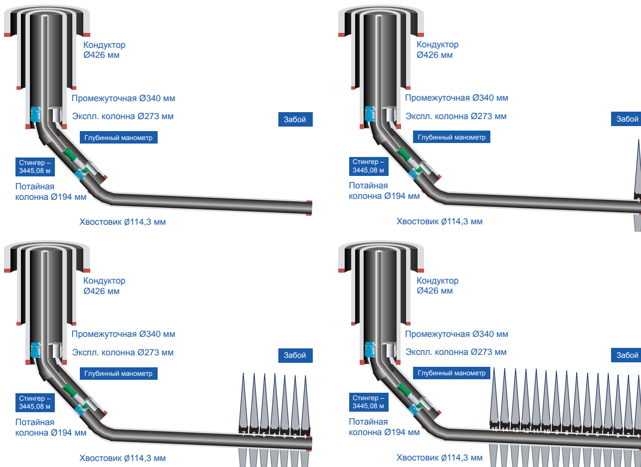
Рис. 3. Этапы освоения скважины Fig. 3. Well development stages
