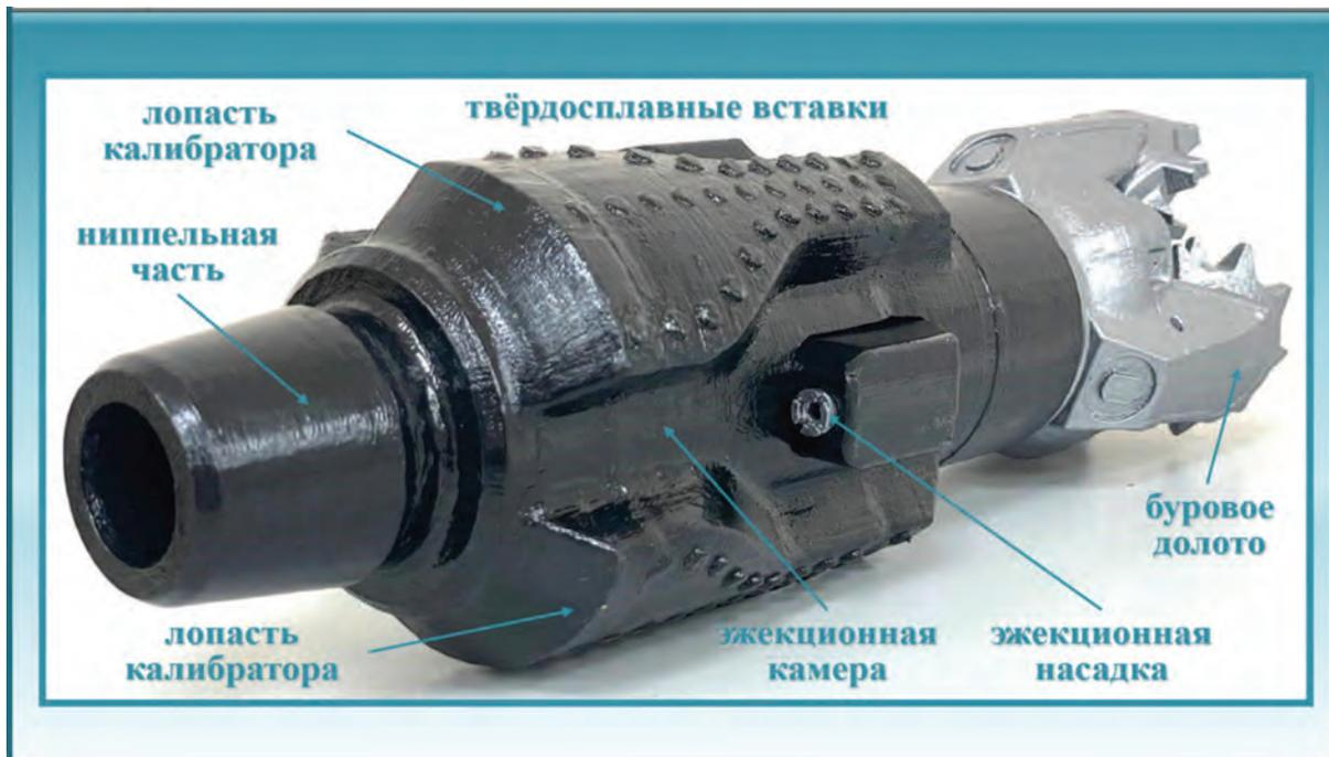
**Рис. 1.** Модель калибратора эжектора в сборе с буровым шарошечным долотом, изготовленная с помощью 3D-технологий
