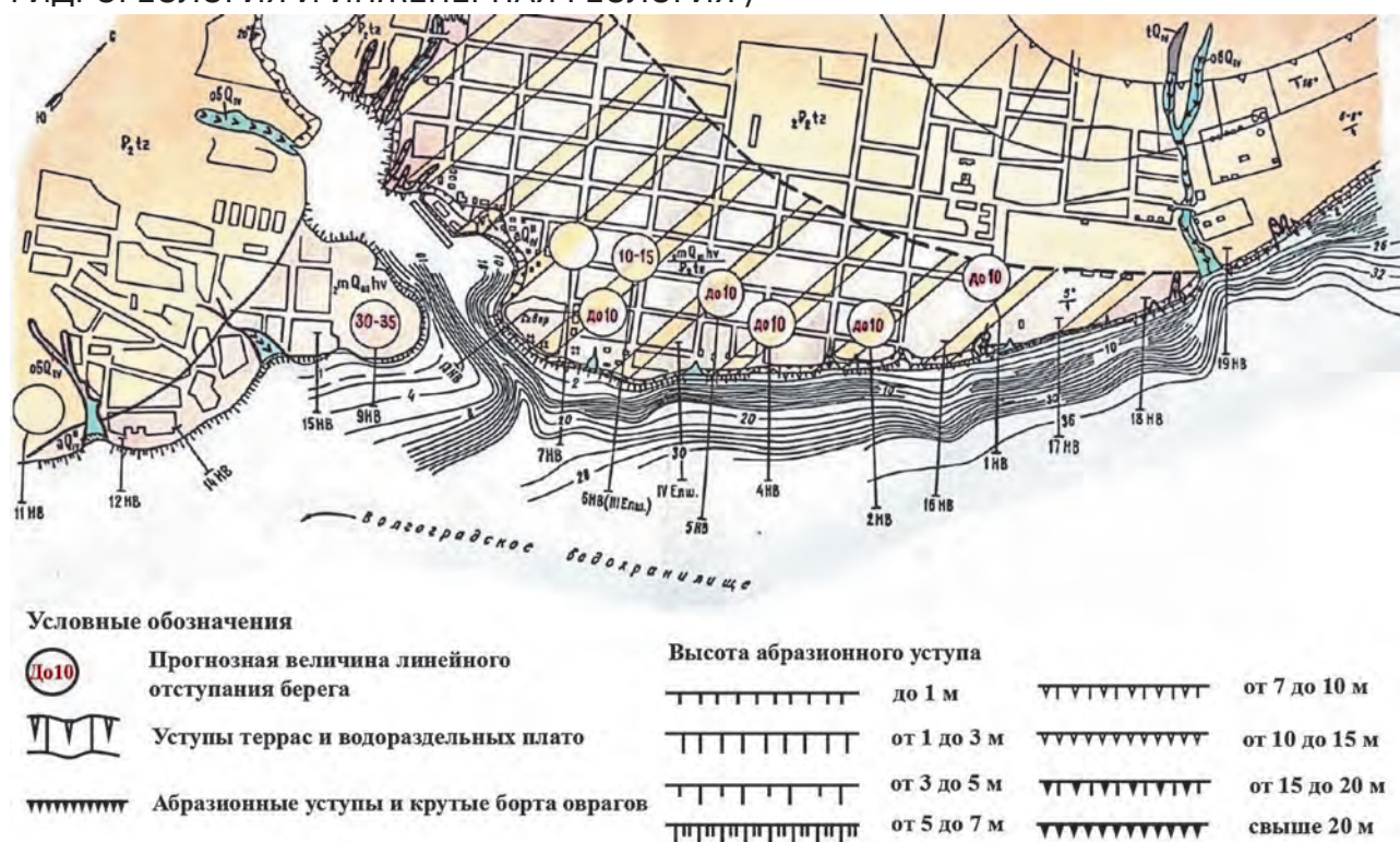
Рис. 1. Пример типизации прибрежной территории по степени активности процесса переработки берега Fig. 1. An example of typifying a coastal area by the degree of shoreline recycling activity
