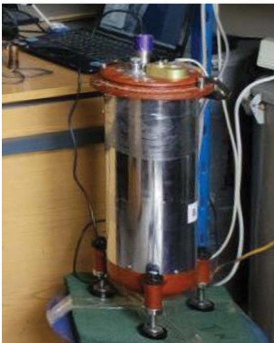
**Рис. 1.** Гравиметр ГНУ-КВ с установленной камерой-микроскопом Levenhuk M35
