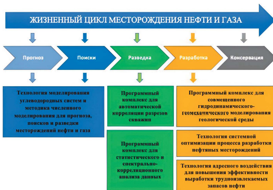
Рис. 4. Технологии моделирования и программы анализа информации на отдельных этапах геолого-разведочных работ и разработки месторождений углеводородов
