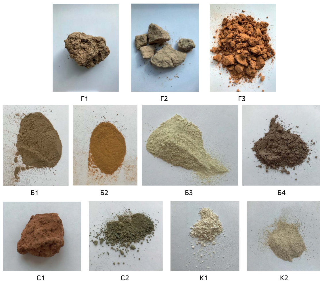
Рис. 1. Исследуемые образцы природных материалов: Г1—Г3 — глины; Б1—Б4 — бентониты; С1—С2 — суглинки, К1—К2 — каолинит и клиноптилолит
