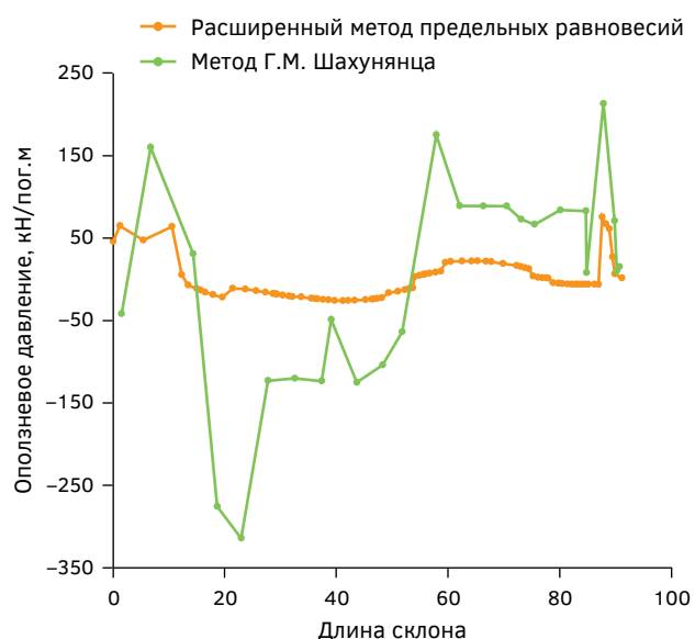
Рис. 5. График распределения оползневого давления вдоль поверхности скольжения
