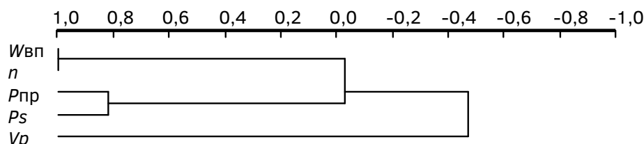
Рис. 2. Взаимосвязи «сейсмической скорости», плотности (природной и минеральной части), пористости и водопоглощения скальных грунтов ( n = 7 , m = 5 ); горизонтальная ось — коэффициент корреляции между признаками (от 0 до +1,0; от 0 до -1,0)
