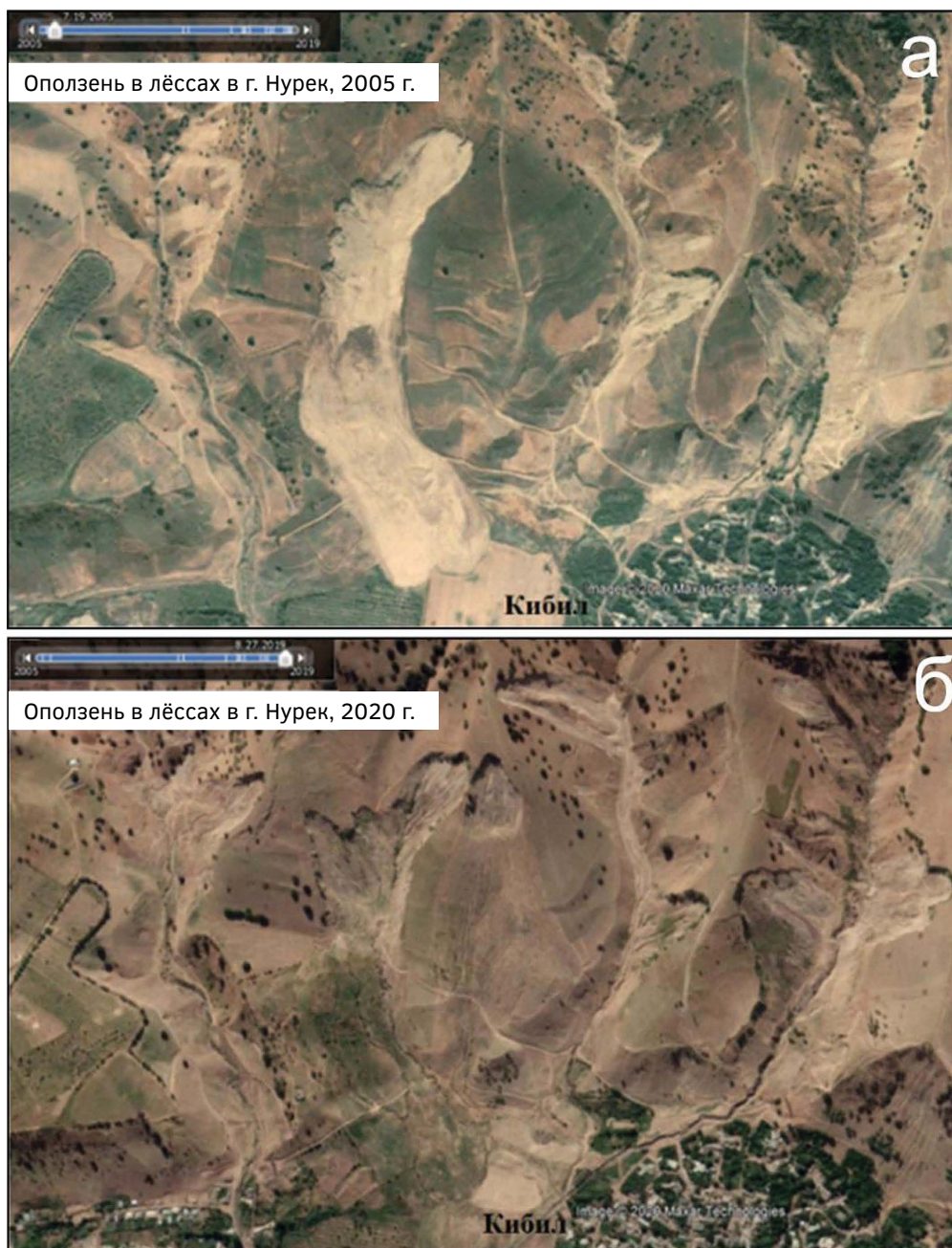
Рис. 5. Развитие оползневого процесса в лёссах во времени, с. Кибил. а — спутниковый снимок 2005 г., б — спутниковый снимок 2020 г.
