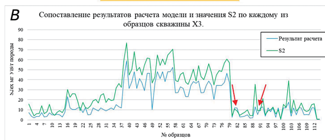
Рис. 10. Сопоставление результатов расчета моделей (А — множественная линейная регрессия; Б — опорная векторная регрессия; В — дерево решений; Г — случайный лес) и значения S2 по каждому из образцов скважины ХЗ
