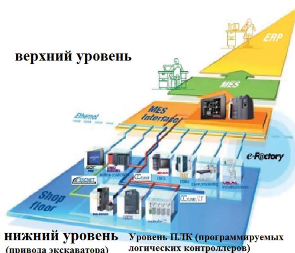
Рис. 1. На нижнем (полевом) уровне находятся датчики, ПЛК и приводы экскаватора Fig. 1. The lower (field) level contains sensors, PLCs and excavator drives
