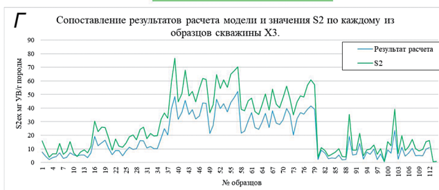
Рис. 10. Сопоставление результатов расчета моделей (А — множественная линейная регрессия; Б — опорная векторная регрессия; В — дерево решений; Г — случайный лес) и значения S2 по каждому из образцов скважины ХЗ
