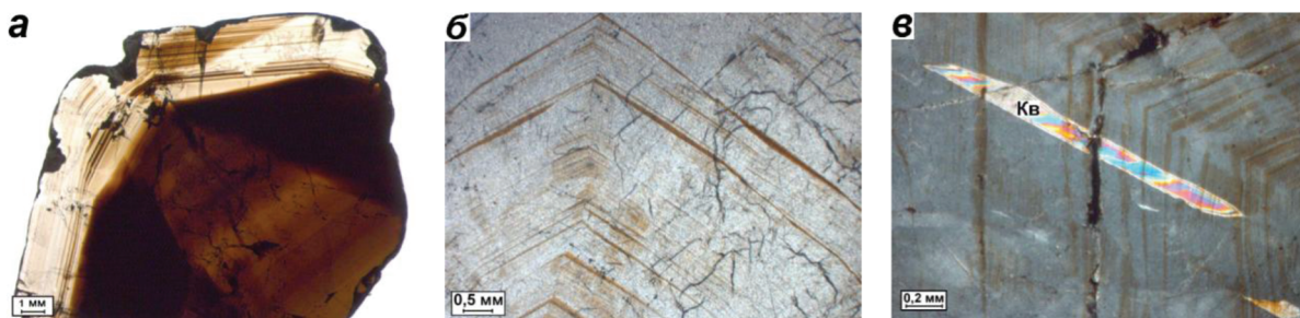
Рис. 3. а — пластина касситерита (толщина 1 мм) с зонально-секториальным окрашиванием; б, в — прозрачные шлифы: б — касситерита с зонально-секториальным окрашиванием, без анализатора, в — восток касситерита (Кв) в основном кристалле, с анализатором
