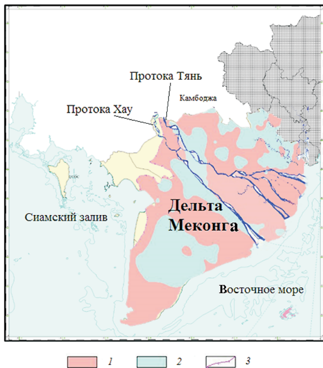
Рис. 1. Карта распределения пресных и минерализованных вод в среднеплейстоценовом горизонте в дельте Меконга, по [2] с изменениями: 1 — минерализованные воды; 2 — пресные воды; 3 — граница водоносного горизонта
