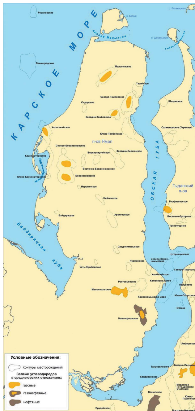
Рис. 3. Схема размещения залежей углеводородов в среднеюрском подкомплексе Ямало-Карского региона Fig. 3. Layout of hydrocarbon deposits in the Middle Jurassic subcomplex of the Yamalo-Kara region
