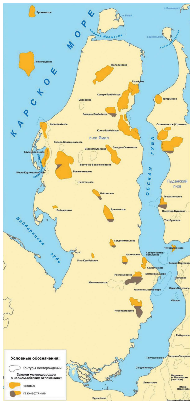
Рис. 2. Схема размещения залежей углеводородов в неоком-аптском-доминантном комплексе Ямало-Карского региона
