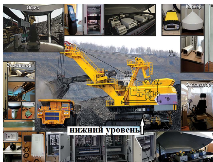
Рис. 1. На нижнем (полевом) уровне находятся датчики, ПЛК и приводы экскаватора Fig. 1. The lower (field) level contains sensors, PLCs and excavator drives
