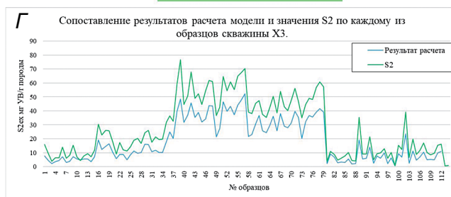
Рис. 10. Сопоставление результатов расчета моделей (А — множественная линейная регрессия; Б — опорная векторная регрессия; В — дерево решений; Г — случайный лес) и значения S2 по каждому из образцов скважины X3
