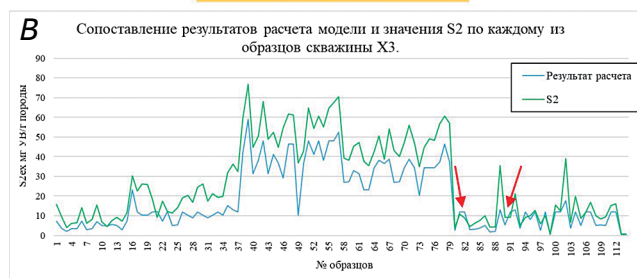
Рис. 10. Сопоставление результатов расчета моделей (А — множественная линейная регрессия; Б — опорная векторная регрессия; В — дерево решений; Г — случайный лес) и значения S2 по каждому из образцов скважины X3
