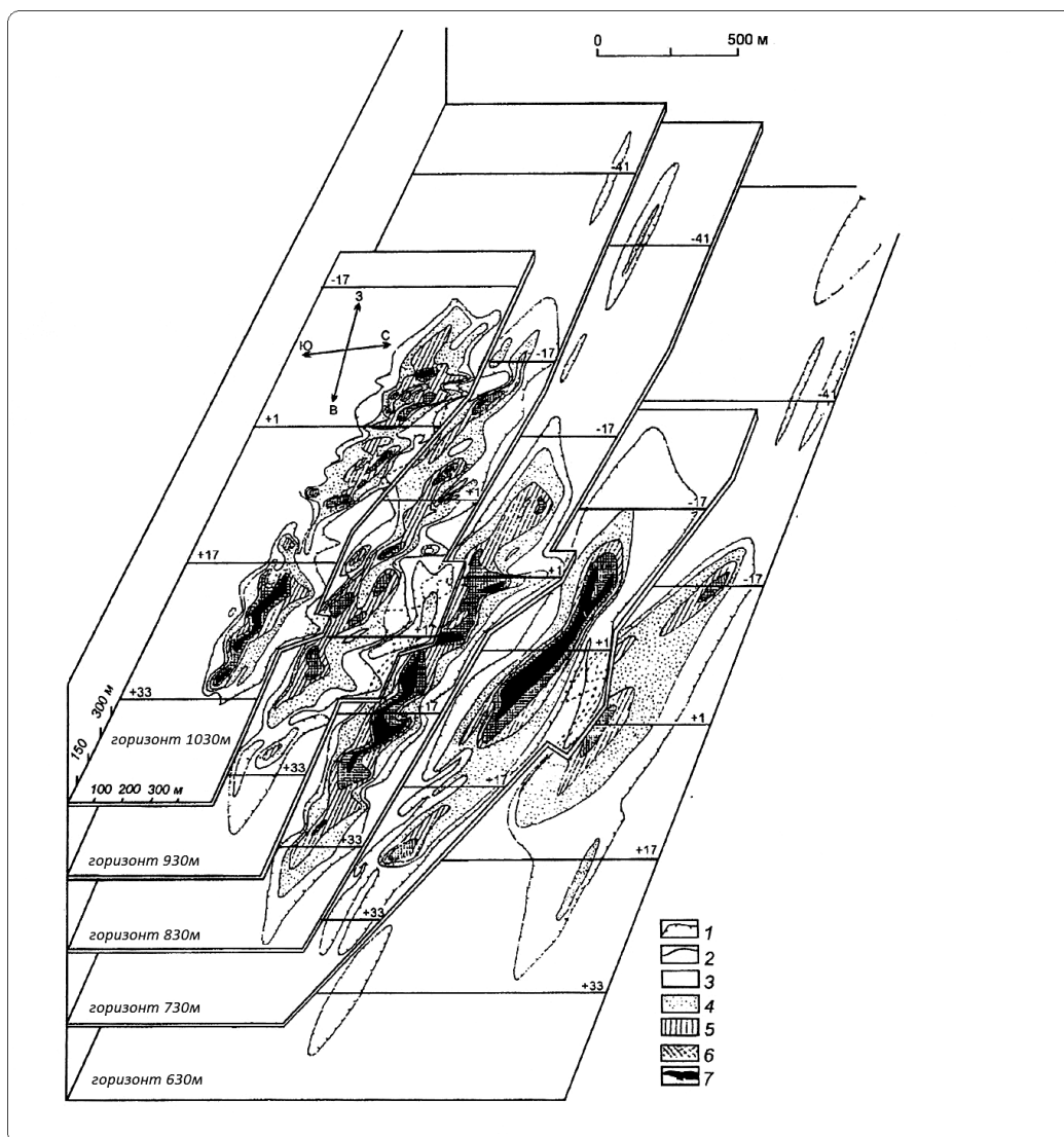
Рис. 5. Блок-диаграмма золоторудной залежи Сухоложского месторождения (по Д.А. Дорофееву). Условными знаками показаны возрастающее среднее содержание золота в залежи: 1 — 0,5 г/т и ниже; 2 — более 0,5 г/т, в том числе: 3 — от 0,5 до 1 г/т; 4 — от 1 до 2 г/т; 5 — от 2 до 3 г/т; 6 — от 3 до 4 г/т; 7 — более 4—5 г/т
