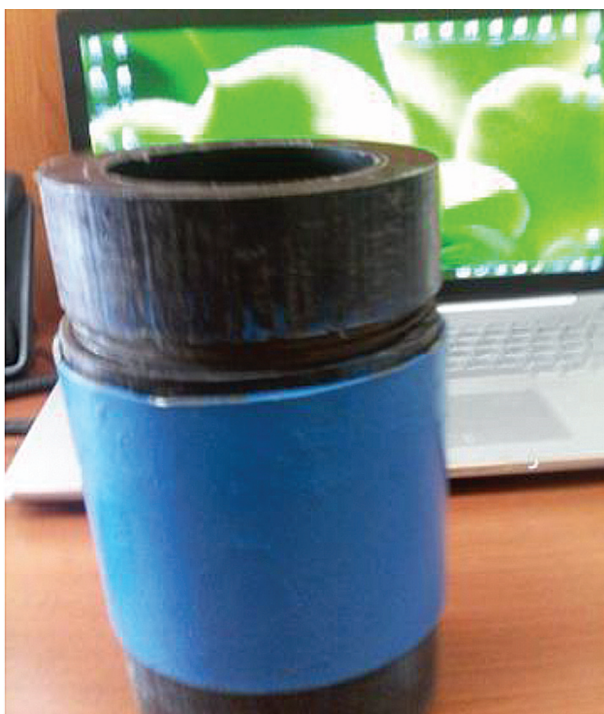
Рис. 5. Защитная металлическая муфта для резьбовых соединений труб ПНД
