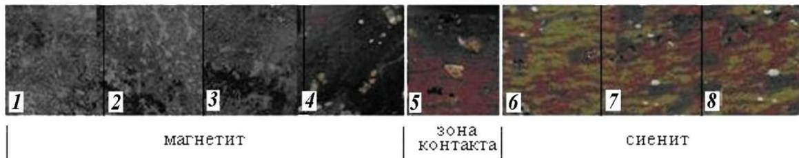
Рис. 2. Фотография полировки образцов-кубиков из контакта сиенит-порфиров с вулканогенно-осадочными породами: числа — номера образцов в полировке
