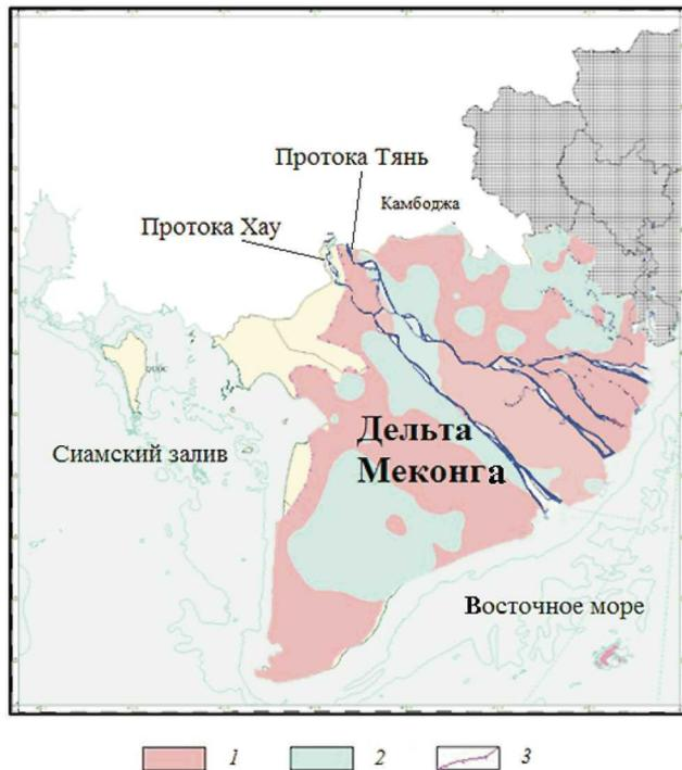
Рис. 1. Карта распределения пресных и минерализованных вод в среднеплейстоценовом горизонте в дельте Меконга, по [2] с изменениями: 1 — минерализованные воды; 2 — пресные воды; 3 — граница водоносного горизонта
