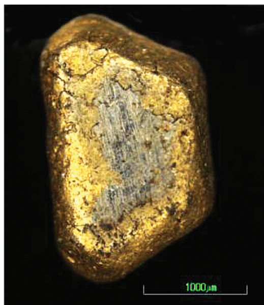
Рис. 5. Гексагональный кристалл Au-Pt 3 Fe из шлиха МН-01131
