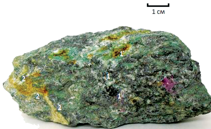
Рис. 1. Рубиноносная флогопит-фуксит-мусковит-скаполитовая порода: 1 — порфиروبластовые зёрна черного скаполита, 2 — секущий прожилок белого скаполита
