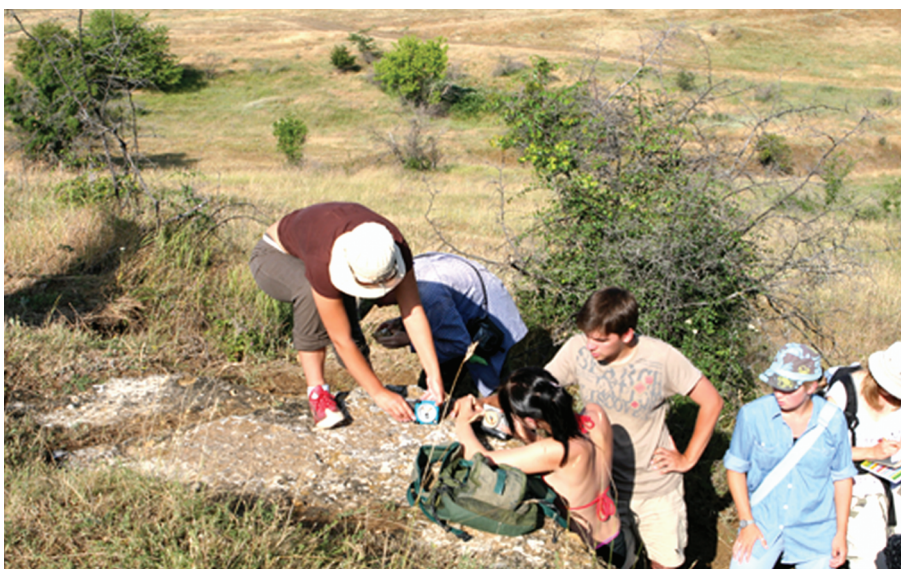
Рис. 3. Измерение геологическим компасом элементов залегания слоёв горных пород нижнего мела
