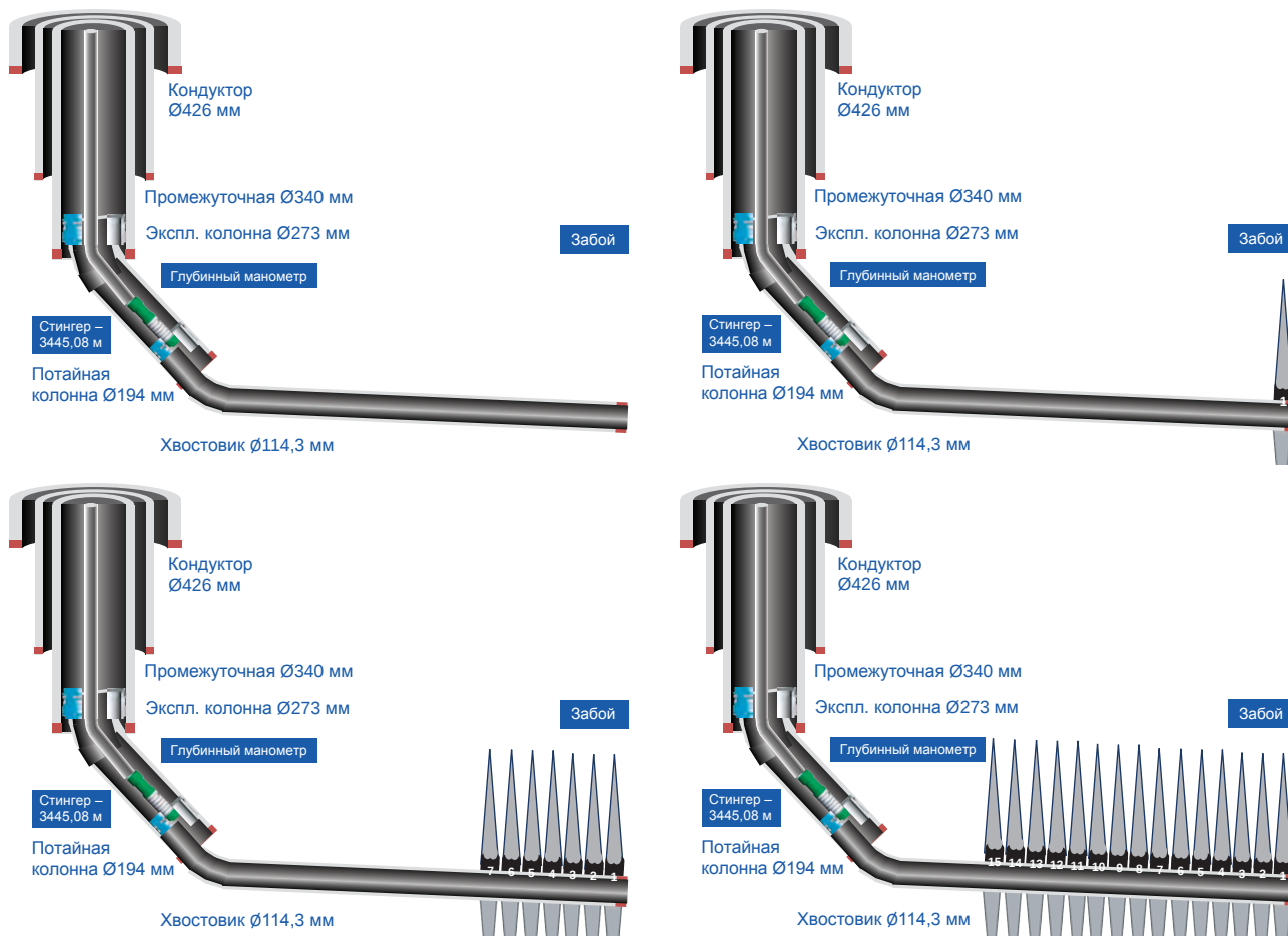
Рис. 3. Этапы освоения скважины Fig. 3. Well development stages
