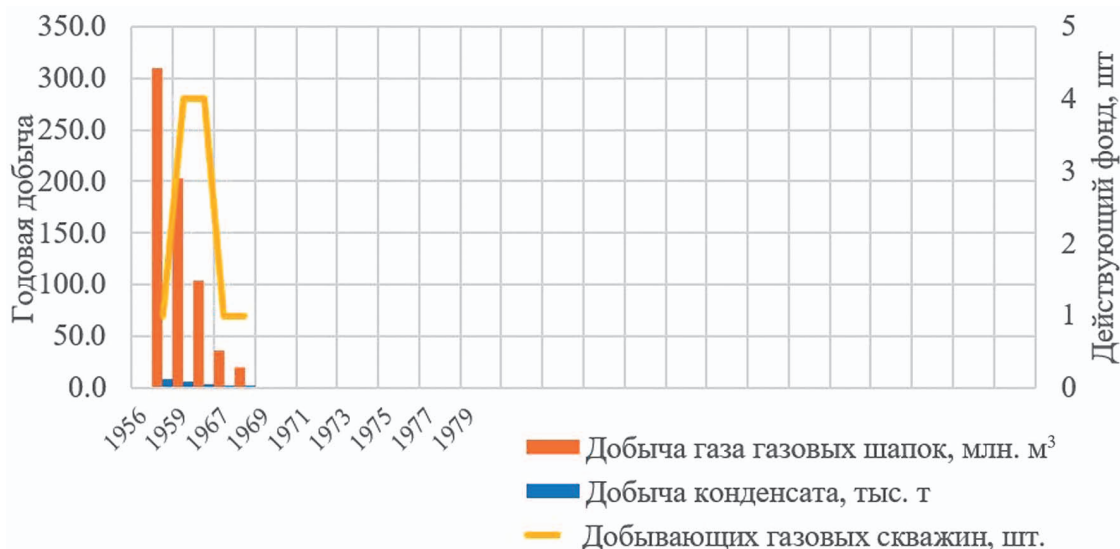
Рис. 4. Динамика основных технологических показателей разработки газа пласта C1bb Горючкинского месторождения
