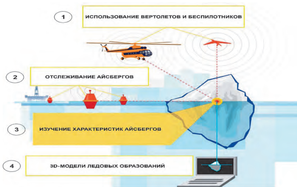
Рис. 3. Экологический мониторинг исследования льдов и айсбергов в Арктике. 1 — выполнено более 700 км полетов для проведения радиолокационной и аэрофотосъемки. Конструирование трехмерных моделей надводной части айсбергов, оценка их массы; 2 — более 100 дрейфующих ледовых буйев. Отслеживание координат и скорости дрейфа; 3 — физико-химические и морфометрические характеристики. Распределение водных масс, течений и изменчивости температур. 2000 айсбергов открыто у восточного побережья архипелага Северная Земля; 4 — собранные научные данные станут основой разработки системы управления ледовой обстановкой шельфовых проектов
