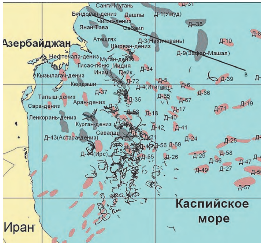
Рис. 4. Соответствие локальных структур осадочного чехла Южно-Каспийской тектонической впадины и пятен нефти, обнаруженных на радиолокационных изображениях. Светло-коричневый цвет — выявленные структуры, темно-серый — перспективные структуры; линия А—В — сейсмический разрез
