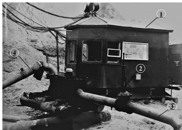
Рис. 10. Общий вид кабины гидромониторщика: 1 — кабина; 2 — задвижка; 3 — водовод; 4 — гидромонитор ГМД-250
